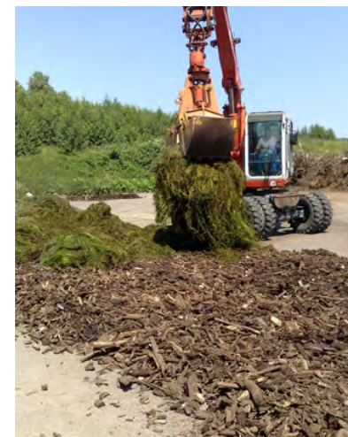
Bild 15: Vorbereitung zur Kompostierung von Elodea : Strukturmaterial (zerkleinertes Treibholz) wird mit gemähtem Elodea -Material durchmischt und zur Kompostierung zu Mieten aufgesetzt
